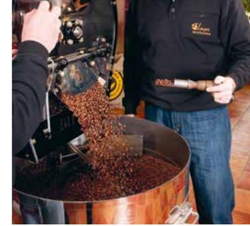
Geröstet wird unser Kaffee mit rotierenden Trommeln in Chargen (Trommelröstung) oder mit Heißluft. Die Röstwärme wird durch Kontakt oder Konvektion (Heißluft) auf den Kaffee übertragen.
